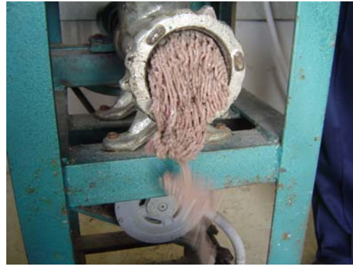
บดวัตถุดิบแบบเปียก (ปลาเป็ด) ด้วยเครื่องโม่ปลา
