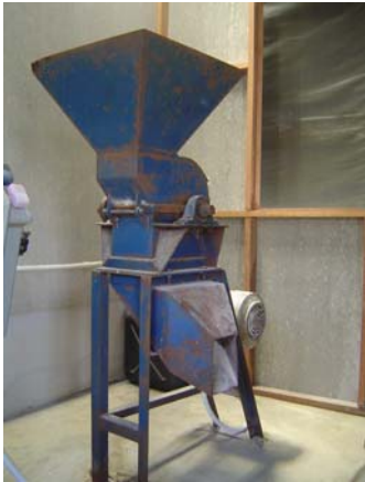
บดวัสดุอาหารแห้งให้ละเอียดด้วยเครื่องบด วัสดุดิบแบบแห้ง
