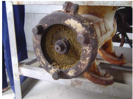
นำอาหารที่ผสมเข้ากันดีแล้ว ไปอัดออกเป็นเส้นด้วยเครื่อง อัดเม็ด
