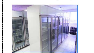
ตู้เย็นควบคุมอุณหภูมิ ขนาด ๔๐ ลูกบาศก์ฟุต ระบบ NO FROST ซึ่งจะรักษาอุณหภูมิความเย็นที่อุณหภูมิไม่เกิน ๕ องศาเซลเซียส
