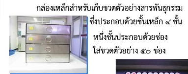
กล่องเหล็กสำหรับเก็บขวดตัวอย่างสารพันธุกรรม ซึ่งประกอบด้วยชั้นเหล็ก ๔ ชั้น หนึ่งชั้นประกอบด้วยช่องใส่ขวดตัวอย่าง ๕๐ ช่อง
